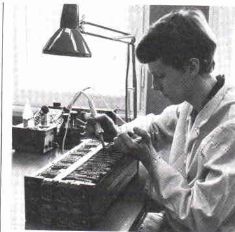
På F 6 Tekniska Enhet löder här Frank Karlsson FFV-U/CVM bort det komponentblock som skall bytas. Foto Arne Johannesson, F 6
