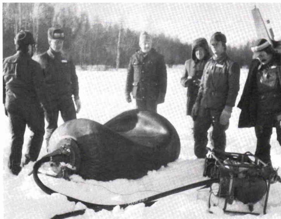
Så här ser det ut i fält under tankning. Bränslet tar man med i gummitanken som hängande last under helikoptern. Folket på bilden är mestadels från arméns helikopterbataljon i Boden. Foto: Kurt Callenäs
