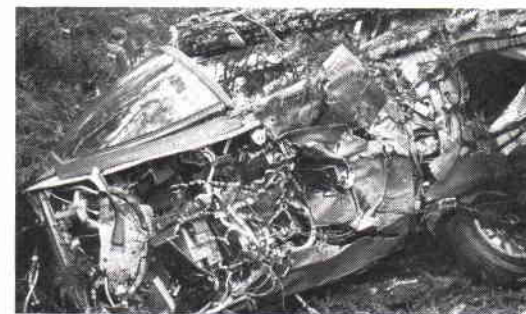
Haveri. Föraren klarade sig med fallskärmen. Orsak: Ett litet sandkorn i bränslesystemet. Foto: Rune Rydh F13
