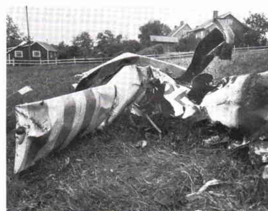
Haveri. Föraren klarade sig med fallskärmen. Orsak: Ett litet sandkorn i bränslesystemet. Foto: Rune Rydh F13
